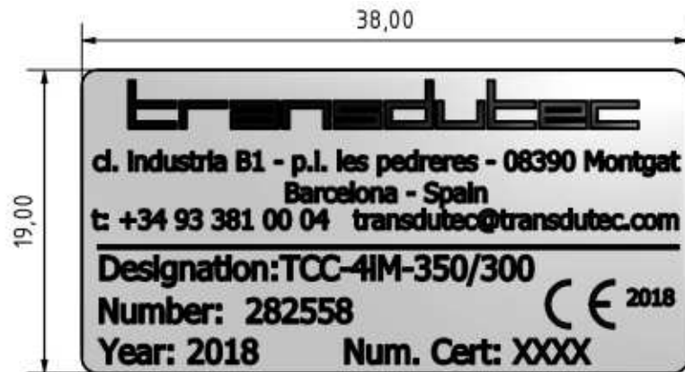
Figura 15.- Plano TCC-4.eti2. Contenido etiquetas célula de carga TCC-4.
